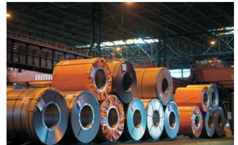
Fotografia nr 5 – przykład właściwego składowania kręgów ocynkowanych Autor: Jeroen Op de Beeck, ArcelorMittal Gent
